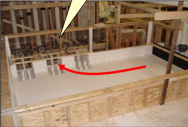
**FIGURE 7: PUMP INTAKE MODEL**
