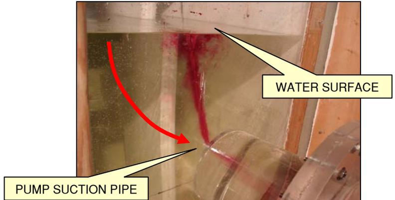
FIGURE 9: SURFACE VORTEXING
