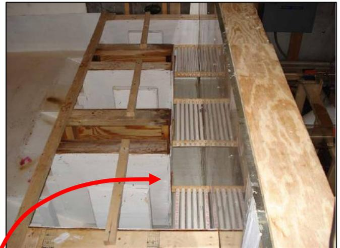
FIGURE 11: SURFACE VORTEX BREAKS
