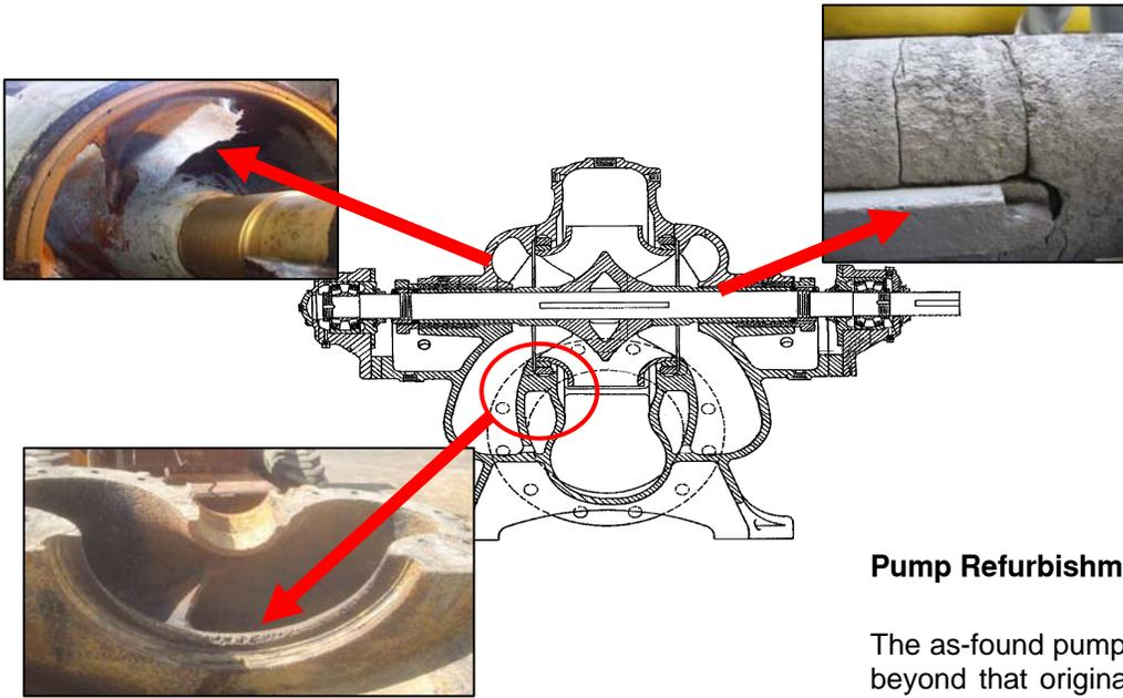
**FIGURE 13: INGERSOLL-RAND MODEL 36AFV**
