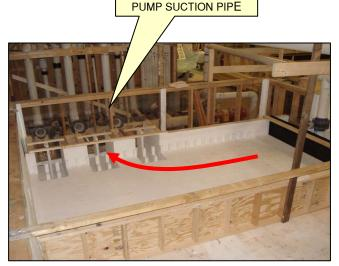
FIGURE 7: PUMP INTAKE MODEL
