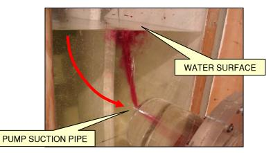
**FIGURE 9: SURFACE VORTEXING**
